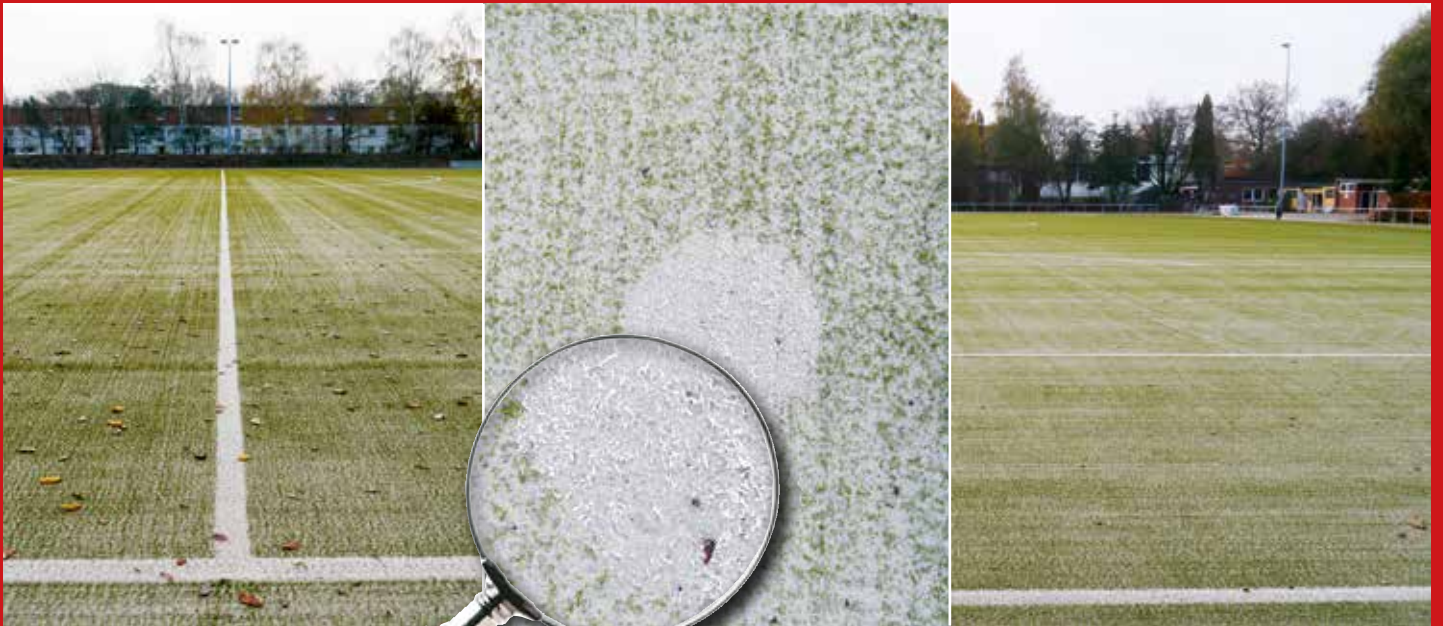
Der „Elfmeterpunkt“ des neuen Kunstrasenplatz von „Polytan“ mit Quarzsandfüllung.
